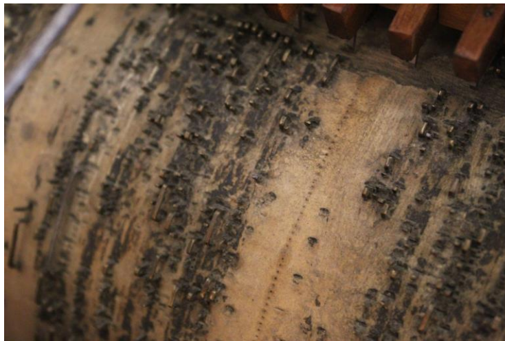
Figura 11: Detalle de un antiguo cilindro intervenido en que se puede apreciar la sucesión de puntos utilizada por Enrique Venegas para marcar las divisiones de tiempos y compases.
